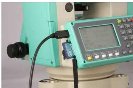
**Interfacciamento con collegamenti USB, possibilità di inserire schede SD per la raccolta dei dati di rilievo**
